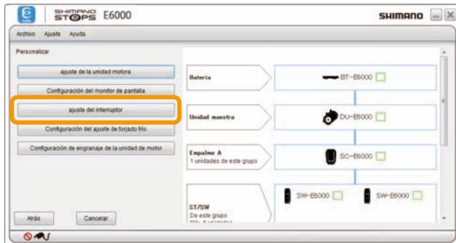
3. Haga clic en [Cambie el modo de ajuste] o [Configuración del interruptor] para ir a cada pantalla de configuración.
